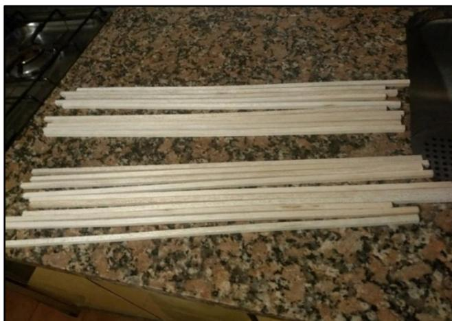
Compré, entonces, un paquete y, cortando las varillas a la mitad, obtuve 20 varillas de 46 cm. Esas varillas fueron unidas de a cuatro, obteniéndose cinco “troncos” de 46 cm por 1,2 cm; el diámetro a escala de los troncos principales que en la realidad eran de 60 cm. Se procedió a cortar los troncos a la medida de la escala 1:50. La KonTiki estaba conformada por un tronco central de más de 9 metros de largo y ocho troncos, cuatro a cada
