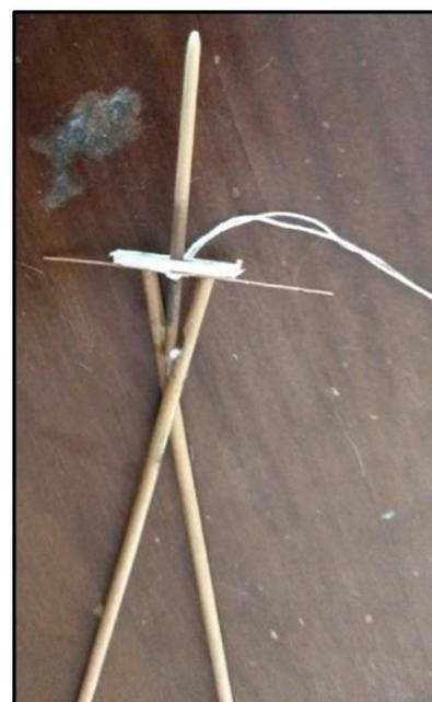
al pegado. Luego, en el extremo superior, le aplané la circunferencia con lima hasta lograr una sección cuadrada que encastrarían en la cofa, la que hice con un trozo de palito de helado cortado y perforado según se ve en la imagen.
