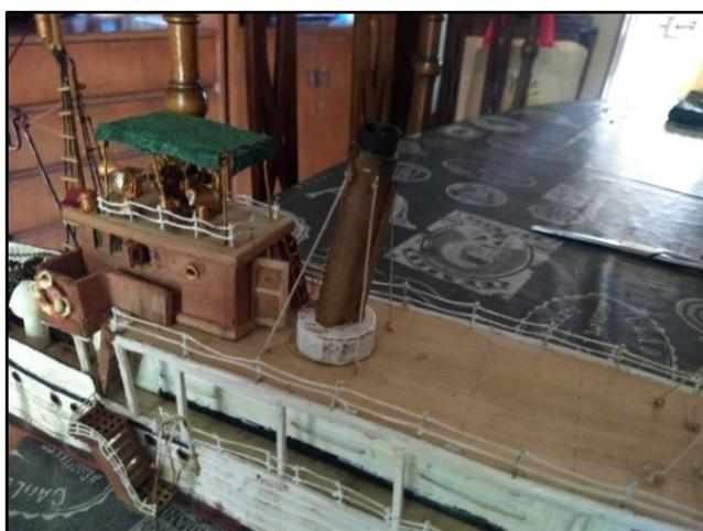
La chimenea fue hecha con un trozo de tubo de sifón, la descarga de vapor es un tanque vacío de birome, la escalerilla es una fila de cañamazo.
