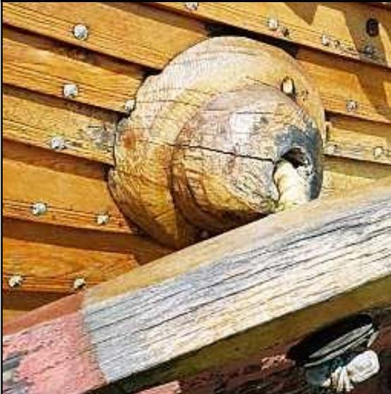
Colocación de los refuerzos de la amura no provistos en el kit y colocación del cinturón porta escudos de madera de cedro de 0.60 mm de espesor
