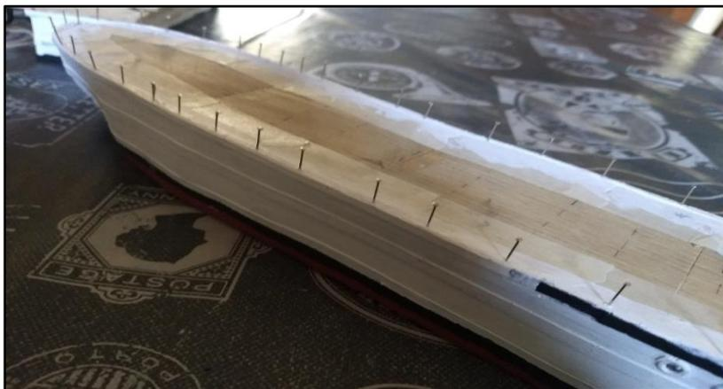
Luego de enmascarar la madera de cubierta con cinta de papel engomada, se pintó el casco con pintura acrílica blanca, se lo encintó para pintarle la línea negra de flotación y se lo encintó una vez más para pintarle, en la parte inferior del casco, una delgada zona de obra viva que se pintó en una mezcla de rojo y marrón. No
