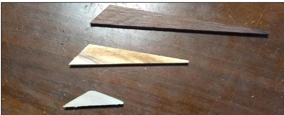
Una corrección: pueden observar que estos triángulos no tienen, exactamente, un Angulo de  $45,50$  o  $30$  grados en el lado menor. Ello se debió a un error de cálculo cuando dibujé las plantillas y, luego, debí cortar el sobrante en cada pieza, una por una. Tenga cuidado. La razón de estos ángulos distintos estriba en que los lados de los rombos, al ser inclinados, van dejando más espacio de lo que se ve y hay que compensarlo cuando se arma la rosa.
