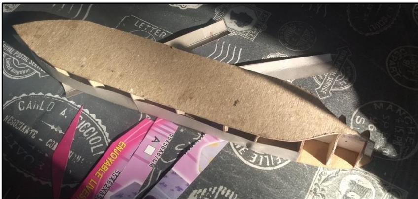
Una vez obtenidas estas tres primeras piezas, en especial la de la línea de flotación que tiene una planta bastante diferente de la de cubierta, marqué correctamente la línea de crujía en ambas plantas e hice coincidir el perfil del casco con estas líneas.
