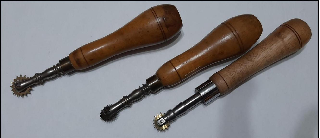
*Herramienta para perforar los puntos de costura, las agujas deben tener la misma separación que las marcas que dejan las herramientas de marcar*
