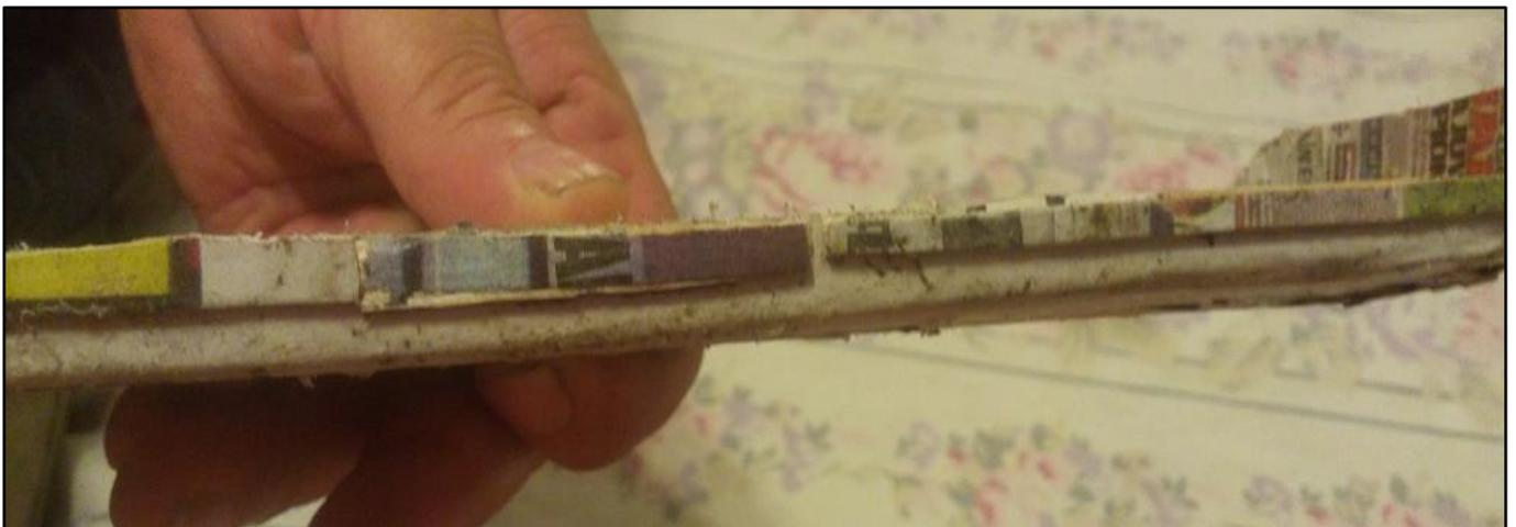
Mientras secaba, se forraron con el mismo material descrito restos de balsa de 1mm, no solo para darle el acabado nombrado, sino para evitar la rotura de una madera de balsa tan delgada. Con estos trozos se construyó el rompeolas de la cubierta de proa, la protección de la cubierta de popa y un cinturón muy delgado que corre a lo largo de todo el casco.
