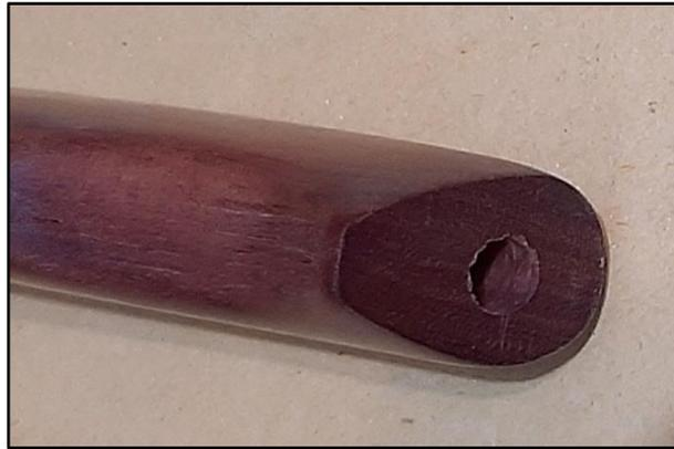
En la parte posterior se ve el orificio por donde se ajustará con una tuerca la hoja y el cabo.
