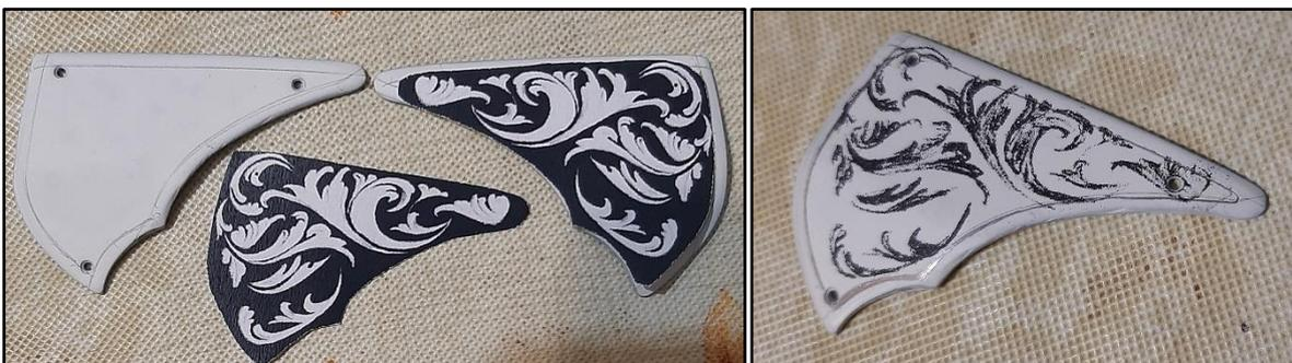
Como ejemplo tomamos las cachas, se pinta la misma con aerosol sintético mate blanco, se imprime motivo en la misma escala que las cachas, se transfiere el mismo con carbónico (solo se requiere buen pulso) y luego con un punzón se saca la pintura de las partes que se van a grabar cuidando de mantener intacta la parte a proteger.
