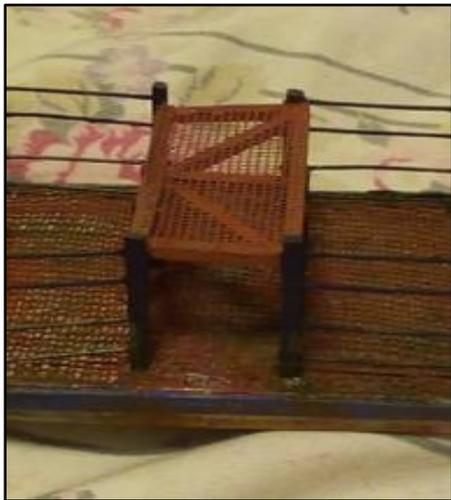
Sobre estos baos y postes se asienta la pasarela que además de una pequeña plataforma a proa de la timonera, cuenta con dos extensiones hacia las bordas en el eje medio transversal del barco, desde donde se operan las puertas levadizas y las rampas basculantes por donde se embarca y desembarca al ganado.
