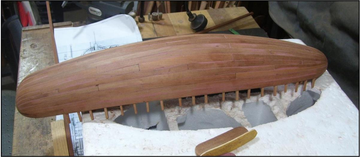
Inmediatamente se retiró esta estructura del molde, continuando con el forrado del casco y los refuerzos interiores. Posteriormente, cuando se avanzó con la construcción interna del casco, se eliminó la quilla.
