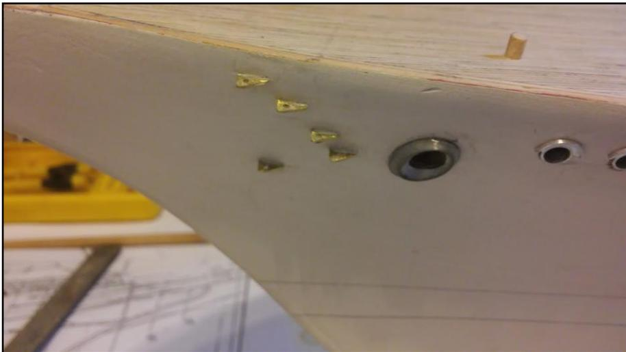
Se realizan dos pequeñas perforaciones en el casco a la altura de las medidas propuestas y se pegan los cáncamos usando pegamento se secado rápido en gel.
