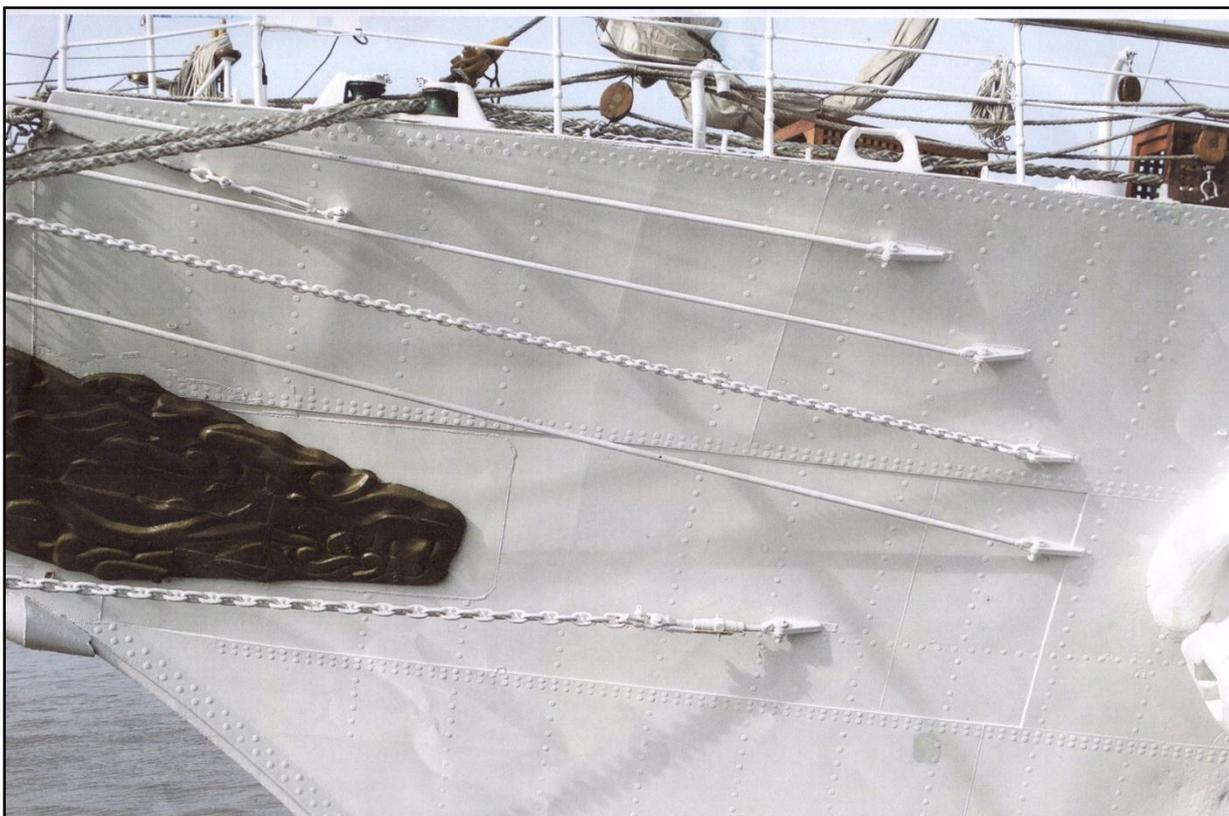
Para construir estos cáncamos, se parte de una lámina de latón de 5 milímetros de ancho. Se lima el extremo dándole ángulo y se le practica una pequeña perforación con una mecha o broca de 0,75 mm.
