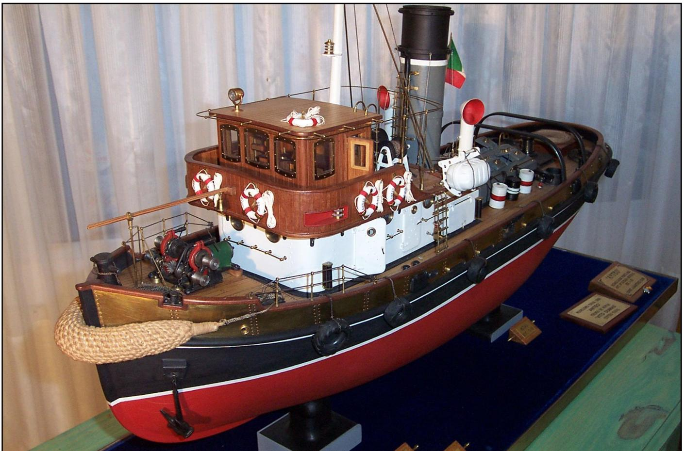
*En este extraordinario modelo de remolcador, el modelista se lució construyendo toda la cabina en chapa de metal remachada, realizó el traqueado de las paredes de la timonera, construyó todo el interior con sus correspondientes elementos, luces y las puertas de la cabina cuentan con sus correspondientes bisagras y cerraduras operativas. Por último agregó un zócalo en ángulo de hierro en todo el perímetro de la cabina*
