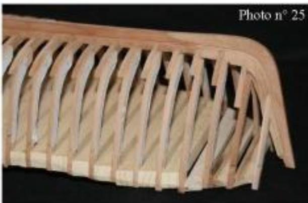
Photo n° 25 – Vue horizontale de la coque renversée, la membrure terminée. Le blocage des couples, en haut et en bas, est évident.
