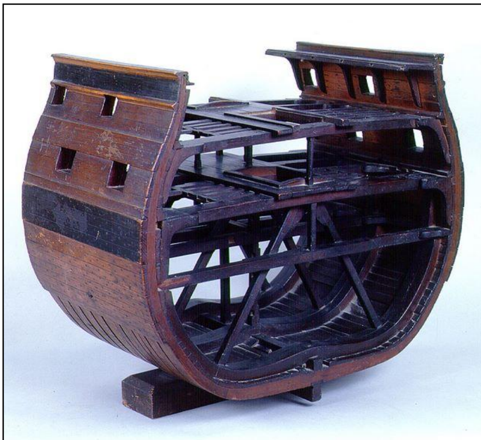
Modelo de la sección por la cuaderna maestra del navío San Genaro.
