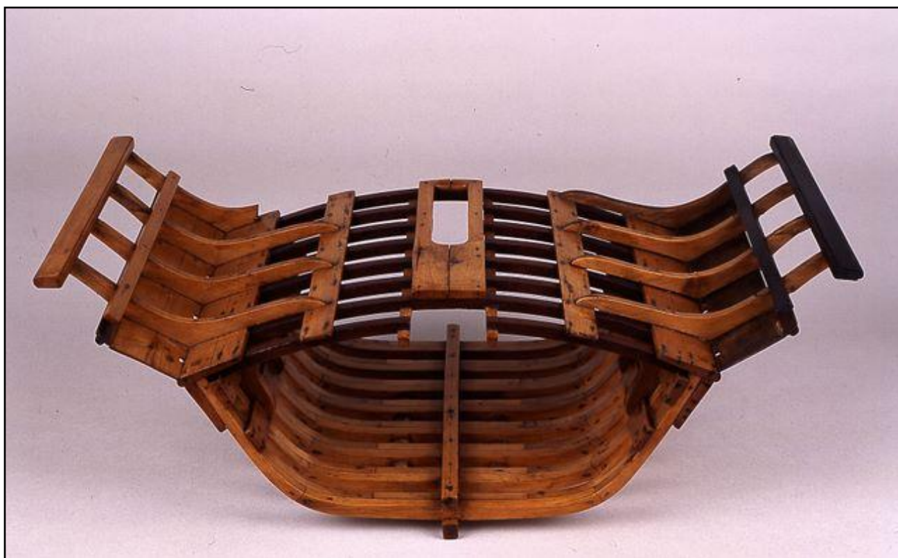
Modelo de sección por la cuaderna maestra de una galera.
