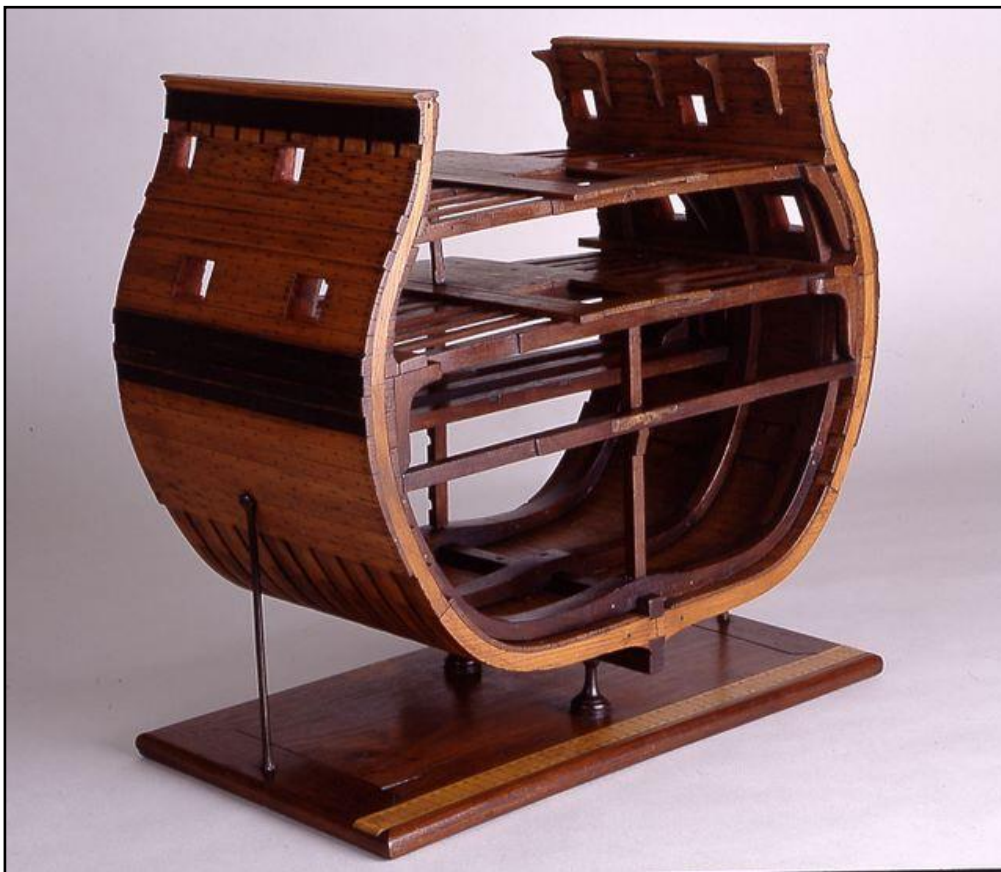
Modelo de la sección por la cuaderna maestra del navío San Juan Nepomuceno.
