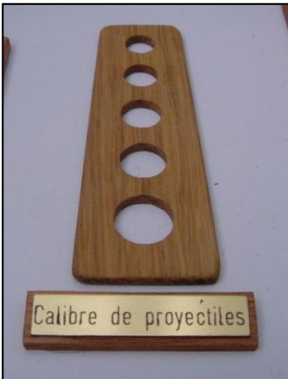
Plancha de madera de roble blanco con las perforaciones en escala de los distintos calibres.
