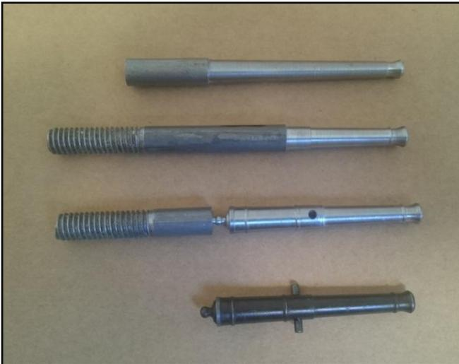
En este otro caso el Modelista decidió construir todos los cañones utilizando el torno. Como material para fabricar el cañón uso tornillos de hierro que es un material excelente para tornearse y agregar detalles.
