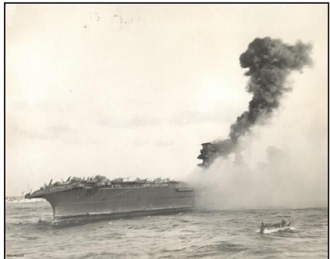
Sin embargo, a las 13 horas, una tremenda explosión, provocada por el incendio de los vapores de gasolina que escapaban de una tubería rota, desgarró el ya maltrecho y torpedeado casco y reavivó varios incendios que estaban prácticamente extinguidos; pese a todo, de la línea de flotación para arriba, el buque seguía lanzando y recuperando aviones pero, para las 15 horas los incendios tomaron tal intensidad que hubo que abandonar el barco el que se hundiría a las 20 horas de ese mismo día.
