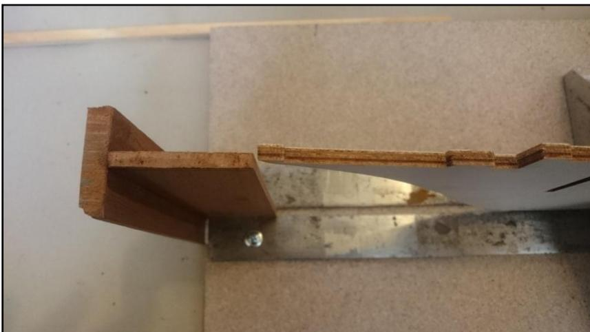
En esta fotografía se puede observar la deformación de la pieza de quilla la cual corregimos con suplementos pegados a una escuadra que aseguramos con tronillos en los extremos de la tabla base.
