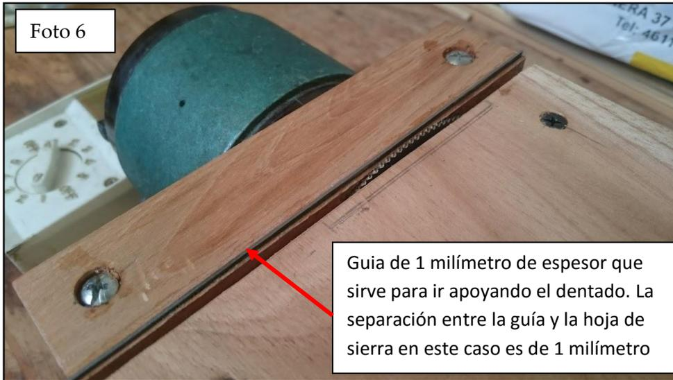
Foto 6: La sierra que se muestra en la fotografía y con la que se ha realizado el trabajo es una herramienta de fabricación artesanal.
