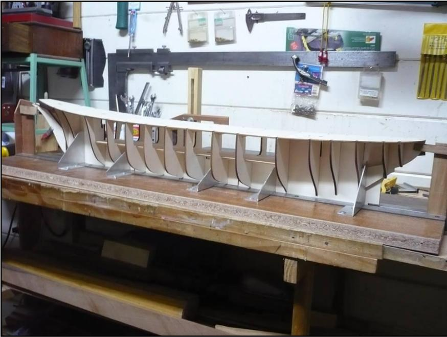
Una vez ensamblados todos los componentes; llámese cuadernas, quilla, cubierta y refuerzos sobre astillero comprobamos que todas las piezas ensamblan correctamente y forman un conjunto armonioso lo que nos permite encarar el próximo paso que será el pegado de todas las piezas sin sacarlo de astillero para que mantenga en todo momento la alineación.
