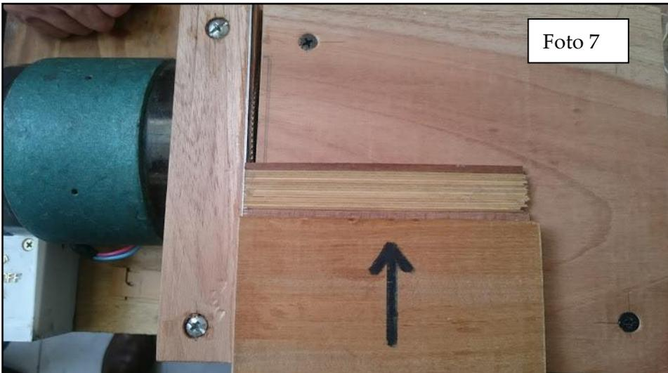
Foto 7: Apoyando el conjunto de tracas sobre la mesa de la sierra y contra el listón guía, ayudado por una tablita cortada perfectamente a escuadra, se realiza el corte de la primera ranura, la segunda ranura se realiza poniendo la primer ranura cortada en la guía y así sucesivamente hasta terminar, foto 8.
