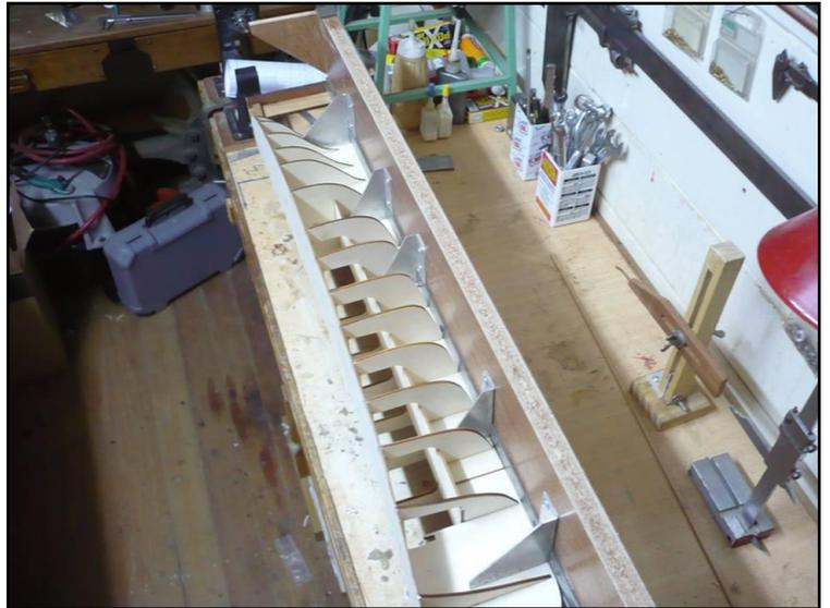
Nuevamente se espera el secado de la cola y se retira el modelo del astillero para poder invertirlo y reforzar la parte inferior de la cubierta como se ve en la fotografía.
