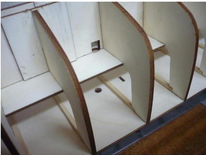
El modelo ya se puede retirar del astillero y gracias a todos los pasos que hemos visto hasta aquí obtenemos una estructura interna perfectamente derecha y escuadrada.
