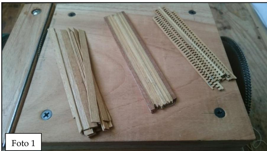
En la foto 1 se ven las tres etapas del material necesario. Primero, las tracas cortadas todas a la misma medida; en el centro, las mismas tracas que se han pegado solamente en los extremos y se les agregó un listón al principio y al final para evitar que se astille la última traca al pasar por la sierra; y, por último, las tiras dentadas o peines listos para ensamblar.
