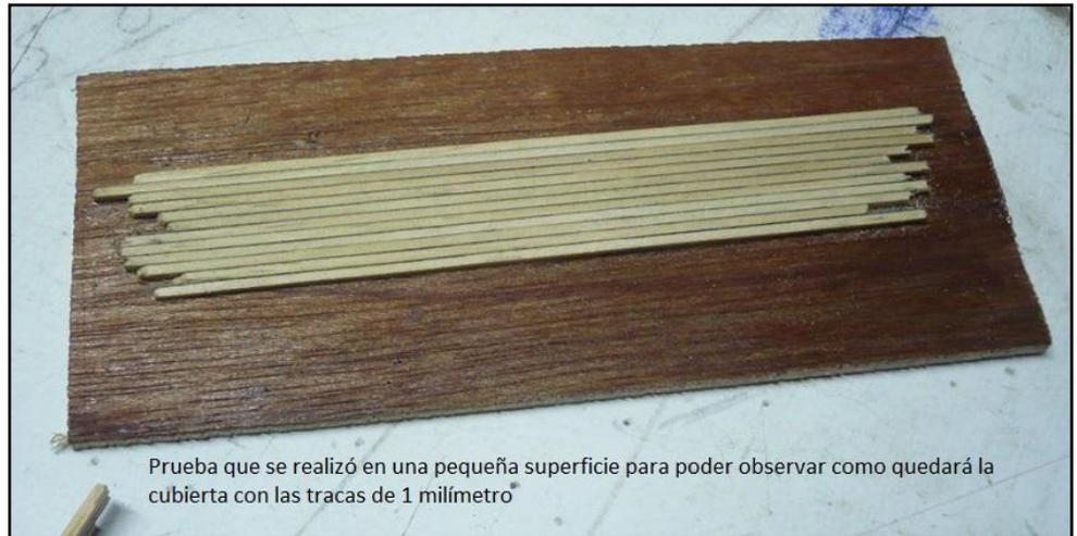
Prueba que se realizó en una pequeña superficie para poder observar como quedará la cubierta con las tracas de 1 milímetro
