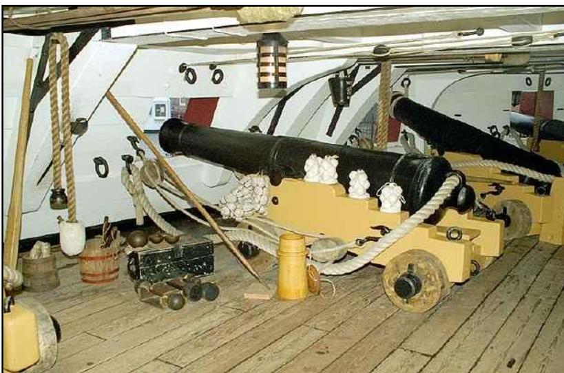
Los cañones de batería, de los que se describió el proceso de fundido y sus partes anteriormente, eran un tubo cerrado en un extremo y abierto en el otro y provisto de un orificio (el oído) por donde se encendía la pólvora y de "muñones" para apoyarlo en la cureña
