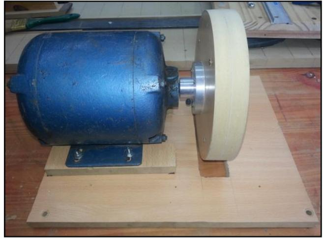
Presentar el motor con el disco sobre la base de madera y como en este caso es bastante grande el diámetro del disco se realizó una abertura en la misma base como se ve en las fotos
