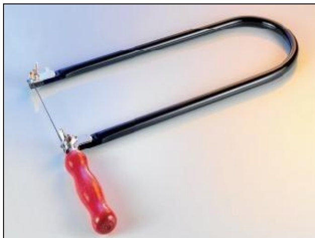
Arco de sierra para calar manual una de las más baratas y mejores soluciones a la hora de cortar cuadernas
