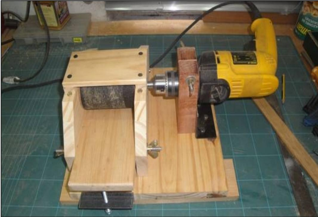
Esta lijadora está pensada para aquellos modelistas que estén interesados en dar un mejor acabado a las maderas necesarias para la construcción del modelo. Se pueden fabricar distintos cilindros con diferentes granos de lija.
