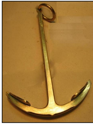
Uña ya soldada , ancla pulida y terminada solo queda el proceso de ennegrecido y colocar el cepo de madera
