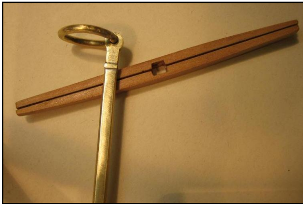
Uña ya soldada , ancla pulida y terminada solo queda el proceso de ennegrecido y colocar el cepo de madera
