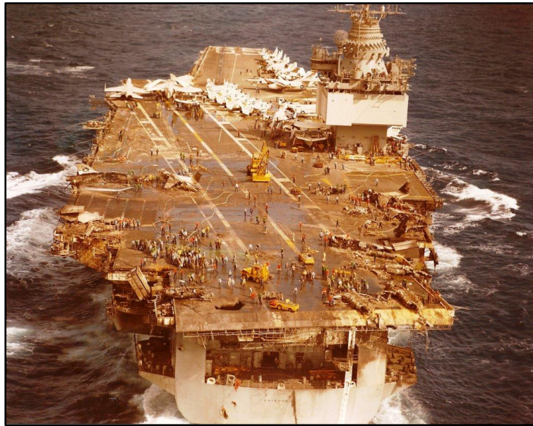
La cubierta de vuelo luego de sufrir un accidente aéreo. Se observan restos de aviones destruidos y la cubierta mojada por el accionar de los grupos antiincendio. Los aviones en cubierta son RA-5 Vigilante, A3D Skywarrior, F4 Phantom, A7 Corsair II, F8 Crusader y E2 Hawkeye.
