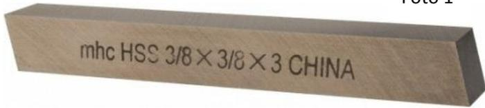
Hay diferentes tipos de herramientas de corte, en función de su uso. Las podríamos clasificar en dos categorías: herramienta hecha de un único material (generalmente acero al cobalto), foto 1 y herramienta con plaquitas de corte industrial. La
