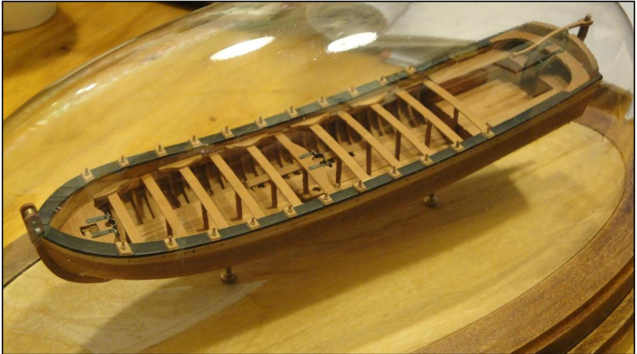
Foto 5 Chalupa de un Navío Francés del siglo XVII construido hasta su más mínimo detalle. El modelo tiene sus pequeños mamparos contruidos con sus correspondientes varengas y genoles, herrajes de hierro, tablazón con su correspondiente tarugado tanto en cubierta como en el forrado exterior del casco. Las maderas utilizadas por el modelista son **peral** para todo el casco y **ébano** para tapa de regala. Modelista Artesano Miguel Lago
