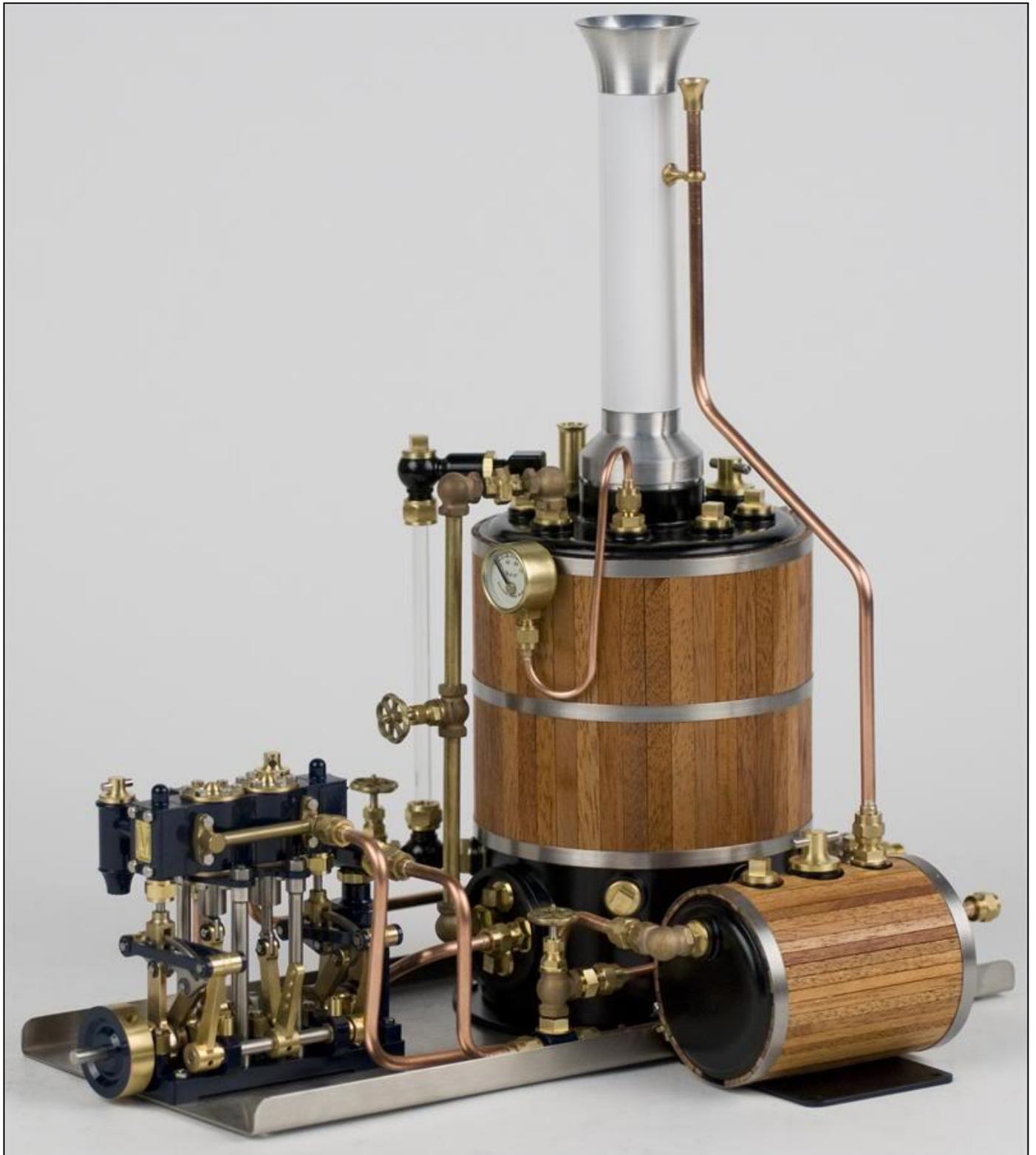
*Motor a vapor comercial listo para instalar en el modelo. Dadas las dimensiones del conjunto, el modelista puede llegar a modificar la escala del barco para que pueda tener en su interior toda esta maquinaria.*
